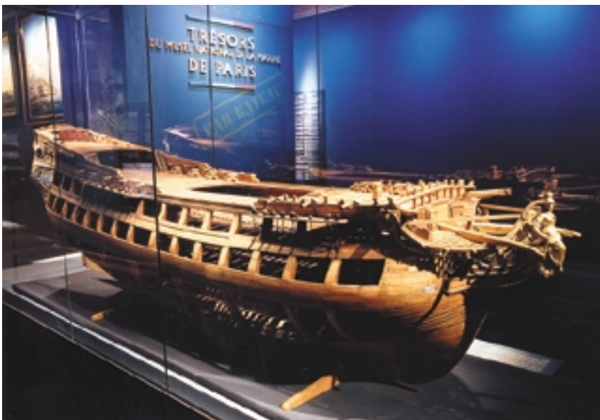
Coque de Pic. Cette coque d'un vaisseau de 74 canons a été achevée par le constructeur Augustin Pic en 1755. Elle a nécessité plus d'un an de travail. Elle a d'abord servi à des fins pédagogiques à l'Académie de Marine de Brest. Ouverte côté tribord, elle laisse voir les aménagements de la cale et des batteries. (Photo: Jacques Lessard, Musée de la Civilisation.)
